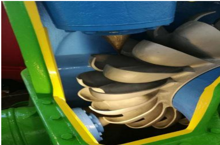
Slika 3: Peltonova turbina za visokotlačne curke (6,5 bara), dva venca lopatic, zgoraj igla in šoba, kjer reguliramo količino curka vode in s tem moč turbine in delovno moč generatorja ( P/f)
