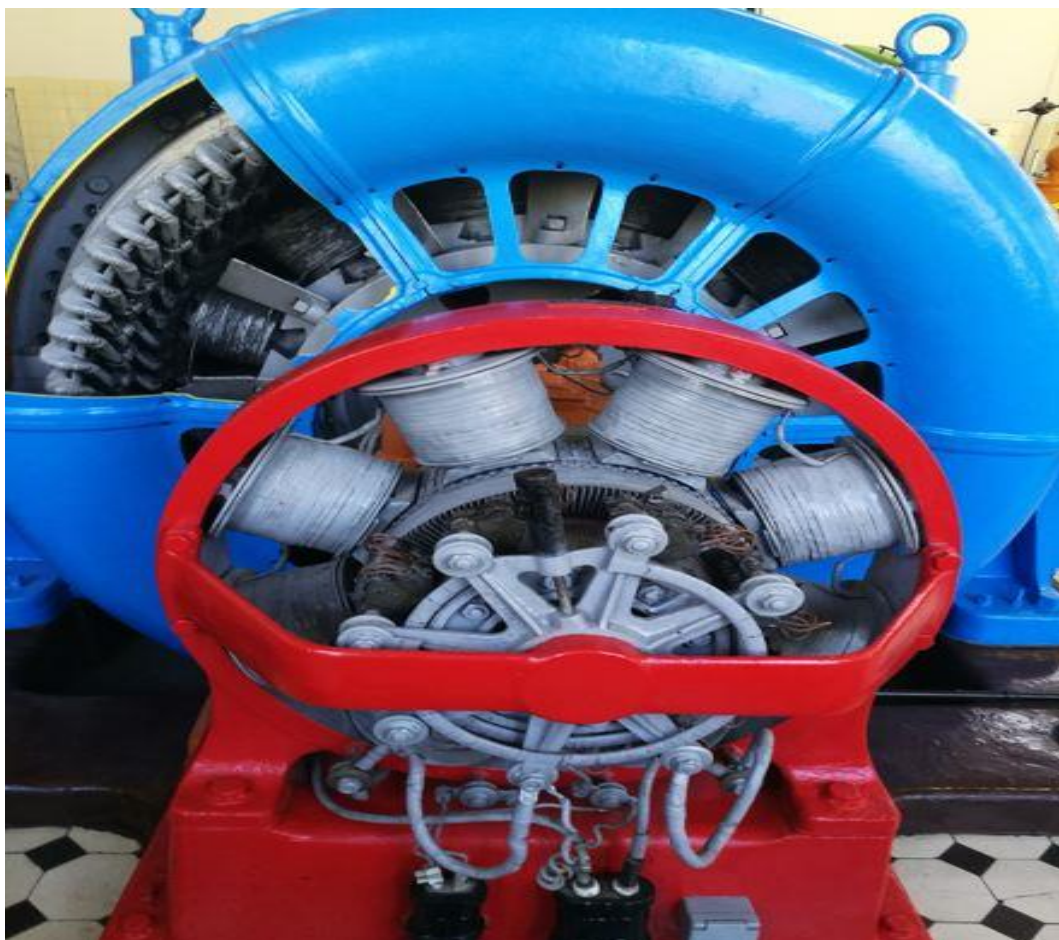
Slika 4: Ward Leonardov agregat (spredaj rdeč DC samovzbudni kolektorski zaporedno vezan generator (D1D2 in A1A2 navitji), zadaj modri 3-f sinhronski generator (hidrogenerator)), v izrezu se
